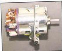
Un bel supporto per ventoline da applicare sul motore; se ne possono montare 3.
